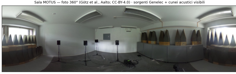
Sala MOTUS — foto 360° (Götz et al., Aalto; CC-BY-4.0) · sorgenti Genelec + cunei acustici visibili
